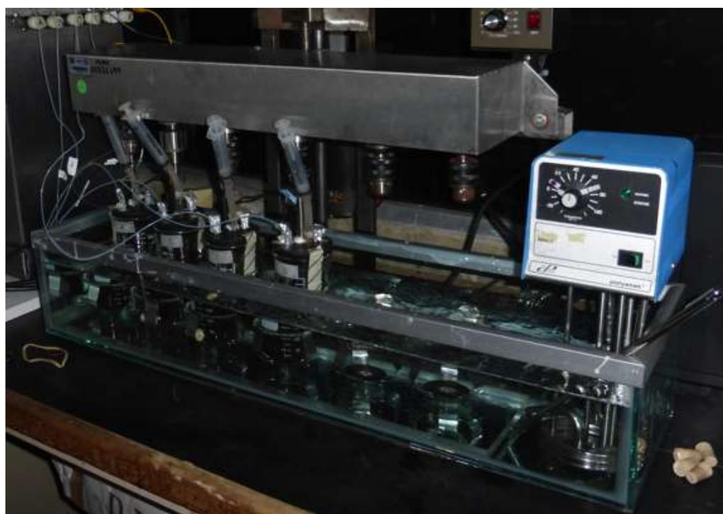
**Figura 6** - Foto do equipamento usado para realizar os ensaios de sacarificação e fermentação sequenciais da esteva deslinhificada.
