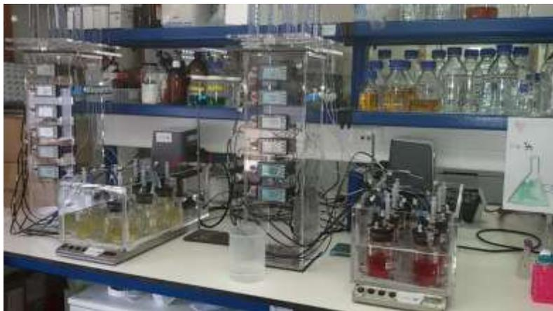
**Figura 5-** Foto dos minireatores construídos no âmbito do projeto SelectEcoli.
